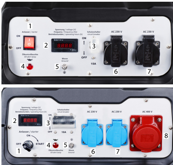
Joonis 5. Juhtpaneel: PG-E 40 SRA (ülemine) ja PG-E 80 TEA (alumine)
