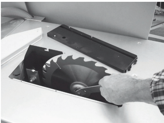
Joonis 25. Saeketta kinnituse avamine kettavõtmega
