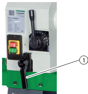
Jn 7. Spindlipuki kinnituse montaaž
