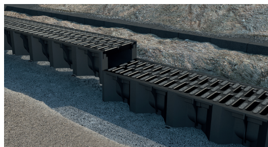
Renne saab käsisaega lühemaks lõigata. Rennid peavad jääma 3-5 mm allapoole kõrvalolevast pinnasekattest.
