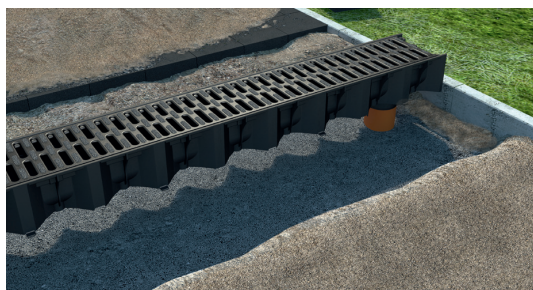
Kõigepealt asetage paika äravooluga renn, seejärel laduge rennid üksteise järel betoonalusele. Rennid on omavahel kergesti ühendatavad.
