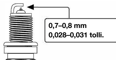
Joonis 29. Kontrollige elektroodide vahekaugust
