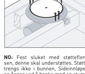
**FI:** Kiinnitä kaivo tukilaipastaan latiaipalkkeihin kolmelta sivulta. Älä tue pohjasta. Avaa tarvittaessa sivulittäntä löymällä tylpällä tapilla. 170 mm aukko lattialevyyn ja kinnitä levy 6:lla 4x50 mm ruuvilla tukilaippaan. Varo, etteivät ruuvit osu putkiin. Täytä kaivon ja levyn välinen rako elastiisella massalla.
