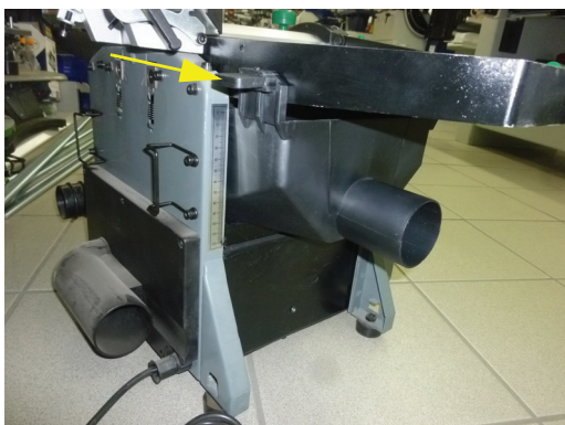
Joonis 6. Laastuäratõmbevarju paigaldamine
