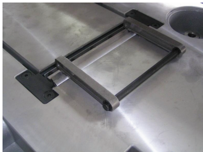
Joonis 13. Kalliibri panek töölauale
