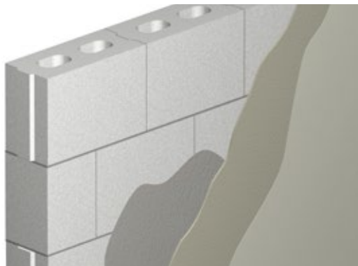
Tellistest ja plokkidest karkassi õhutihedus saavutatakse ühtlase tasanduskihi abil.
