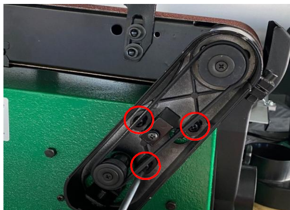
Joonis 11.2. Lõdvendage lihvlindi hoidiku kinnituskruvid.
