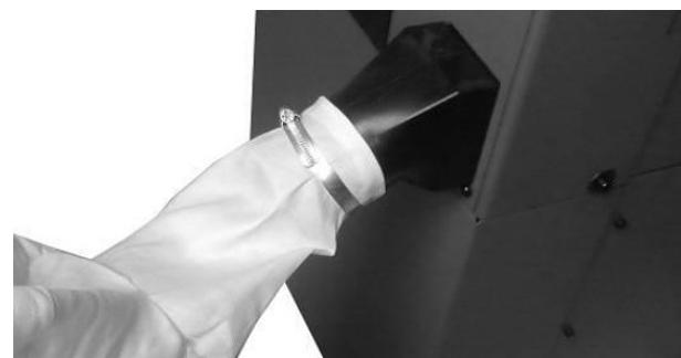
Joonis 14: laastukoti paigaldamine
