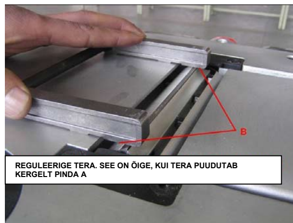
Joonis 33: hõõvliterade reguleerimine pinna B suhtes
