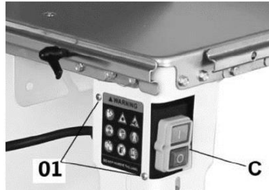
Joonis 9. Lülitiploki paigaldamine
