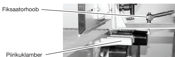
Joonis 15. Etteandelaua külge paigaldamine
