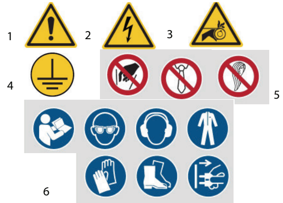
Joonis 1. Ohutussildid | 1 Ohu hoiatus | 2 Ohtliku elektripinge hoiatus | 3 Käte muljumisohu hoiatus | 4 Maanduse sümbol | 5 Keelumärgid | 6 Kohustusedmärgid
